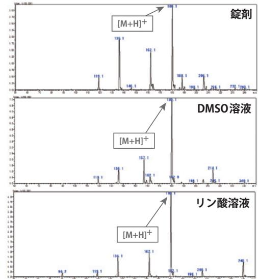
錠剤の分野ではさまざまな形態で同じ化合物を測定する必要があります。ここでは難溶性であるカルボシステイン製剤を粉砕し、各種溶媒に溶かした溶液の測定しました。DMSO溶液、リン酸溶液のようなLCMS分析に適さないサンプルでも測定が可能です。
