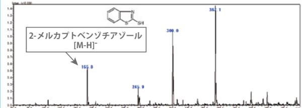
カーボンブラックを含む加硫ゴムなど、溶解が困難な高分子材料も直接分析できるため迅速な測定ができます
