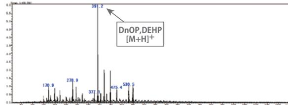
新品の油では添加物と推測できるピークのほか、ラダー状の炭化水素クラスター由来と考えられるピークが見られます。下図の方ではフタル酸エステルが混入したためフタル酸エステルが強く観測されています
