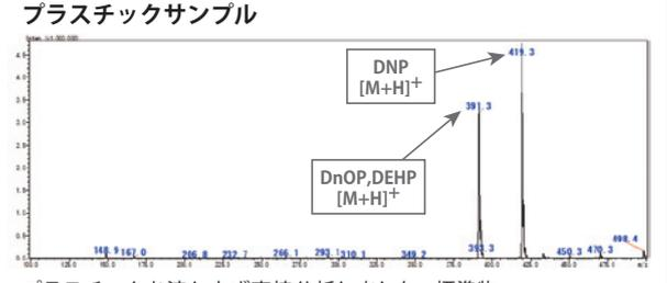
プラスチックを溶かさず直接分析しました。標準物質からはRoHS規制対象すべてのフタル酸エステルが検出されました。プラスチックサンプルからは特定のフタル酸エステルのみが検出されています。
