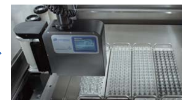
分注ユニットが指定された容器（バイアル・プレート・リアクターなど）まで移動
