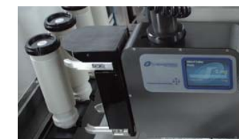
分注ツールが指定されたサンプルカートリッジをピックアップ
