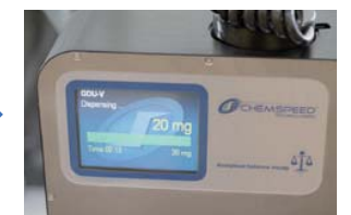
ツールには秤量機能を搭載。カートリッジからの分注量をリアルタイムで測定しながら分注
