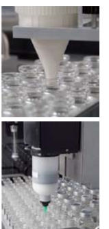
ツールには秤量機能を搭載。カートリッジからの分注量をリアルタイムで測定しながら分注
