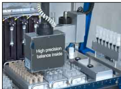
秤量機能付きの分注ツールで固体試料を添加
