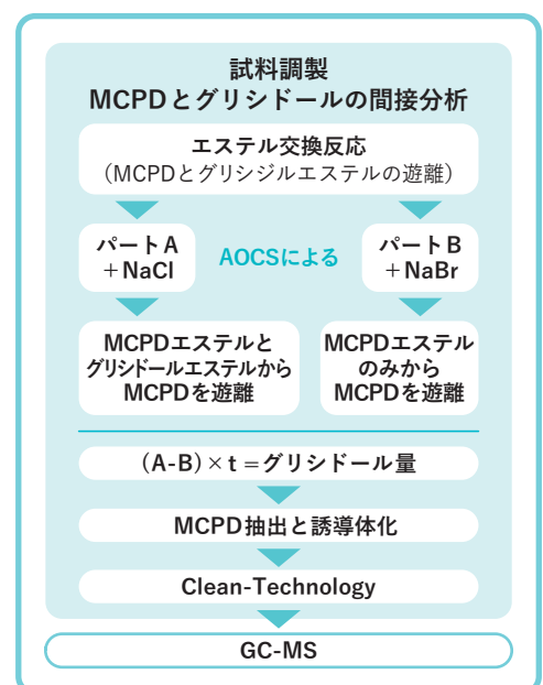
図1 従来のDGF法とDGF Fast & CleanによるMCPDの間接分析のための試料調製のワークフロー
